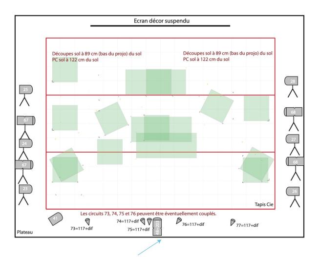
Si la scène est surélevée, placer cette découpe (circuit 48) en perche de face et remplacer par une 614
